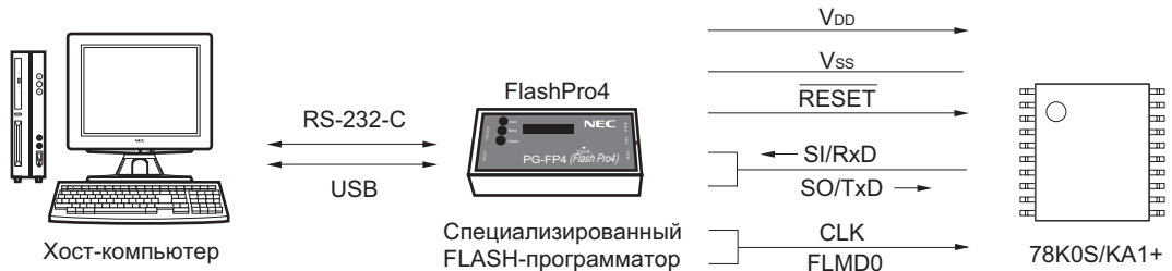
Рисунок 18-3. Средства программирования FLASH-памяти (PG-FPL2)
