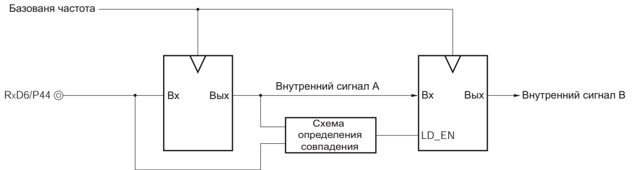
Рисунок 11-21. Схема фильтра шумов
