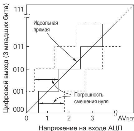
Рисунок 10-17. Погрешность интегральной нелинейности
